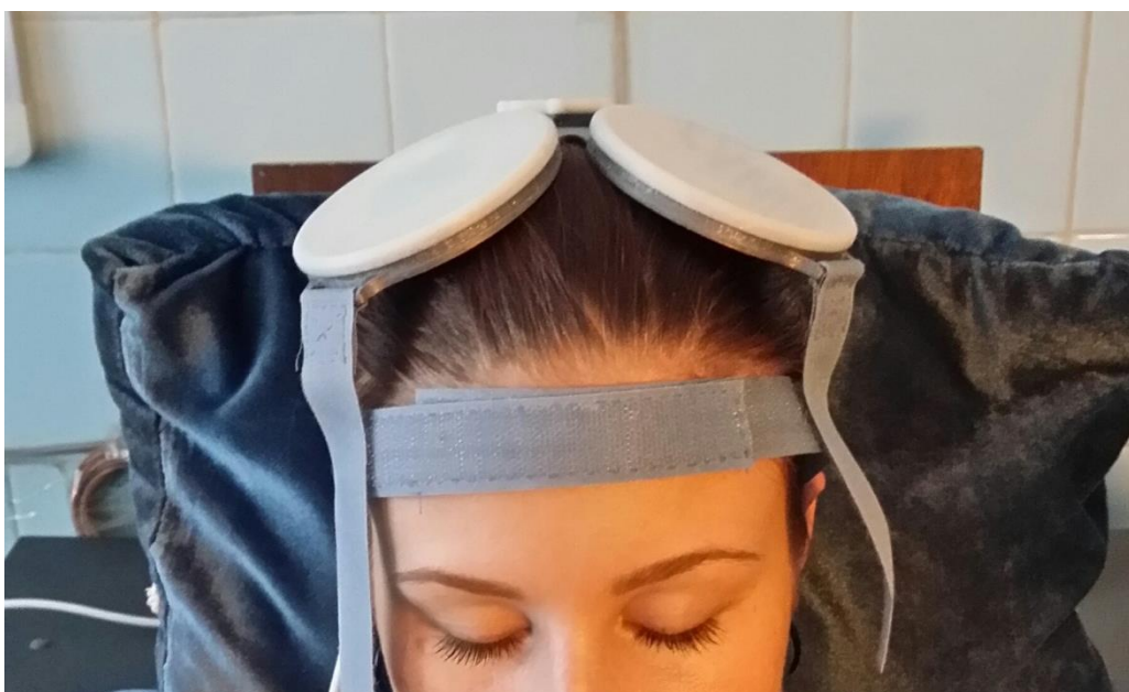
Рисунок 1 – Расположение индукционных вибродатчиков на голове человека
