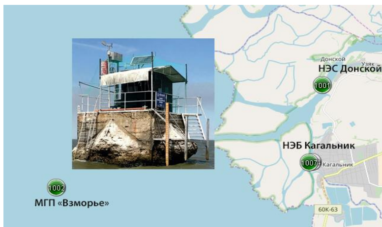
Рисунок 1 – Карта-схема сети ЮНЦ РАН гидрометеорологического мониторинга в устье реки Дон. На врезке представлен созданный в ЮНЦ РАН гидрометеопост «Взморье» находящийся в Таганрогском заливе.
