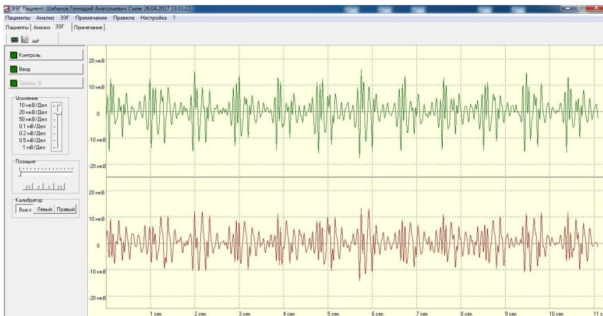
Рисунок 2 – Вид акустического сигнала, снимаемого с головы человека с помощью индукционных вибродатчиков: верхний график – правое полушарие, нижний график – левое полушарие; между вертикальными линиями расстояние по времени 1 сек, по оси ординат – напряжение на выходе датчиков в мкВ
