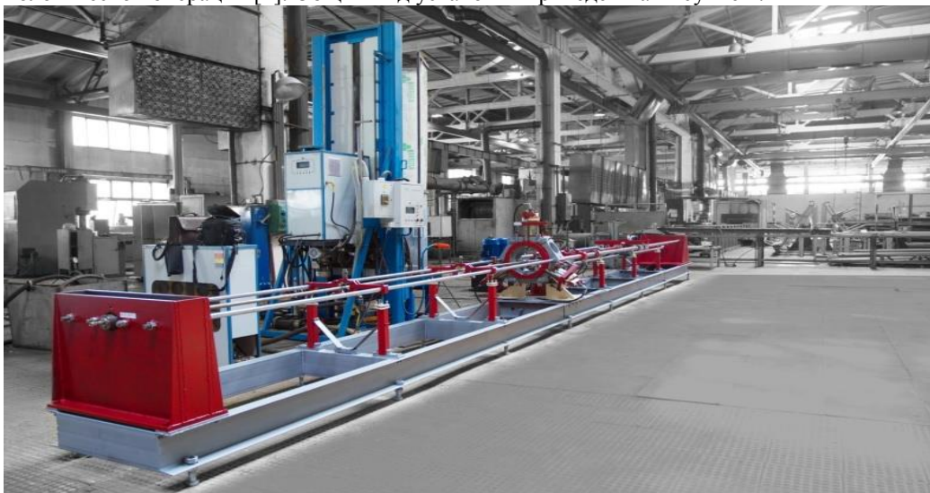
Рисунок 1 – Общий вид установки ВТМО
